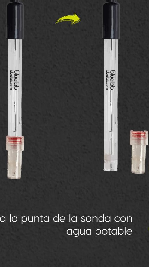
2 Enjuaga la punta de la sonda con agua potable
