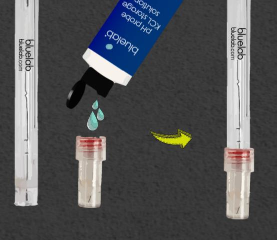
7 Agrega *solución de almacenamiento KCL para sonda de pH Bluelab* en la tapa de almacenamiento, cubriendo por completo la punta de la sonda y pon la tapa.
